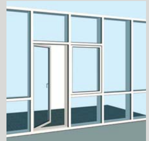
Beispiel Fassadenausschnitt Pfosten-Riegelaufteilung
